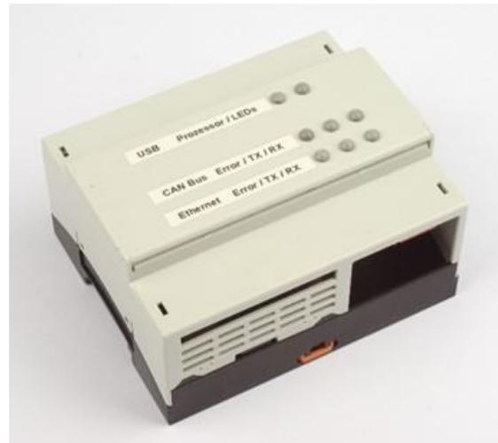
Raspberry Pi im Hutschienengehäuse
