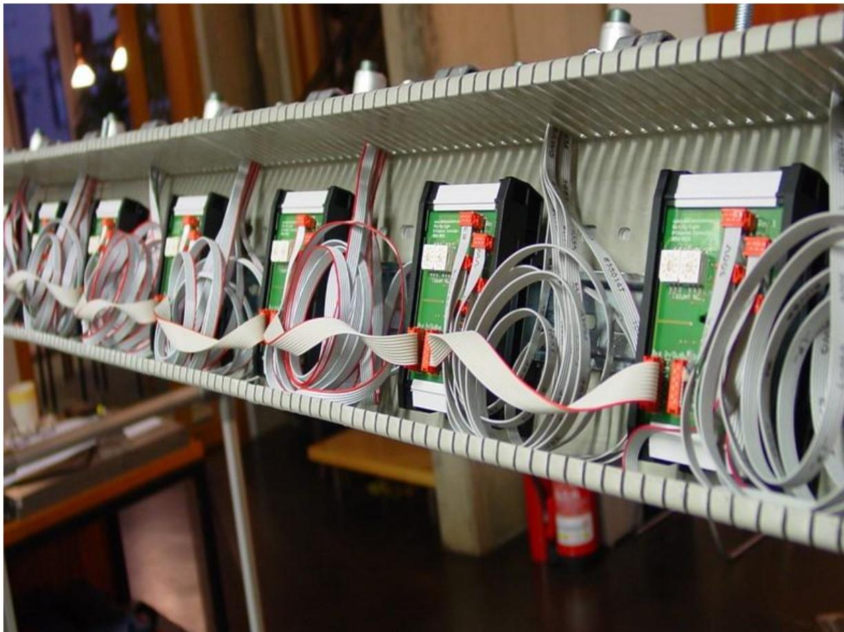
Fertig eingebaute Controller in einem Verdrahtungskanal, flexible Montage auf 35 mm Hutschiene
